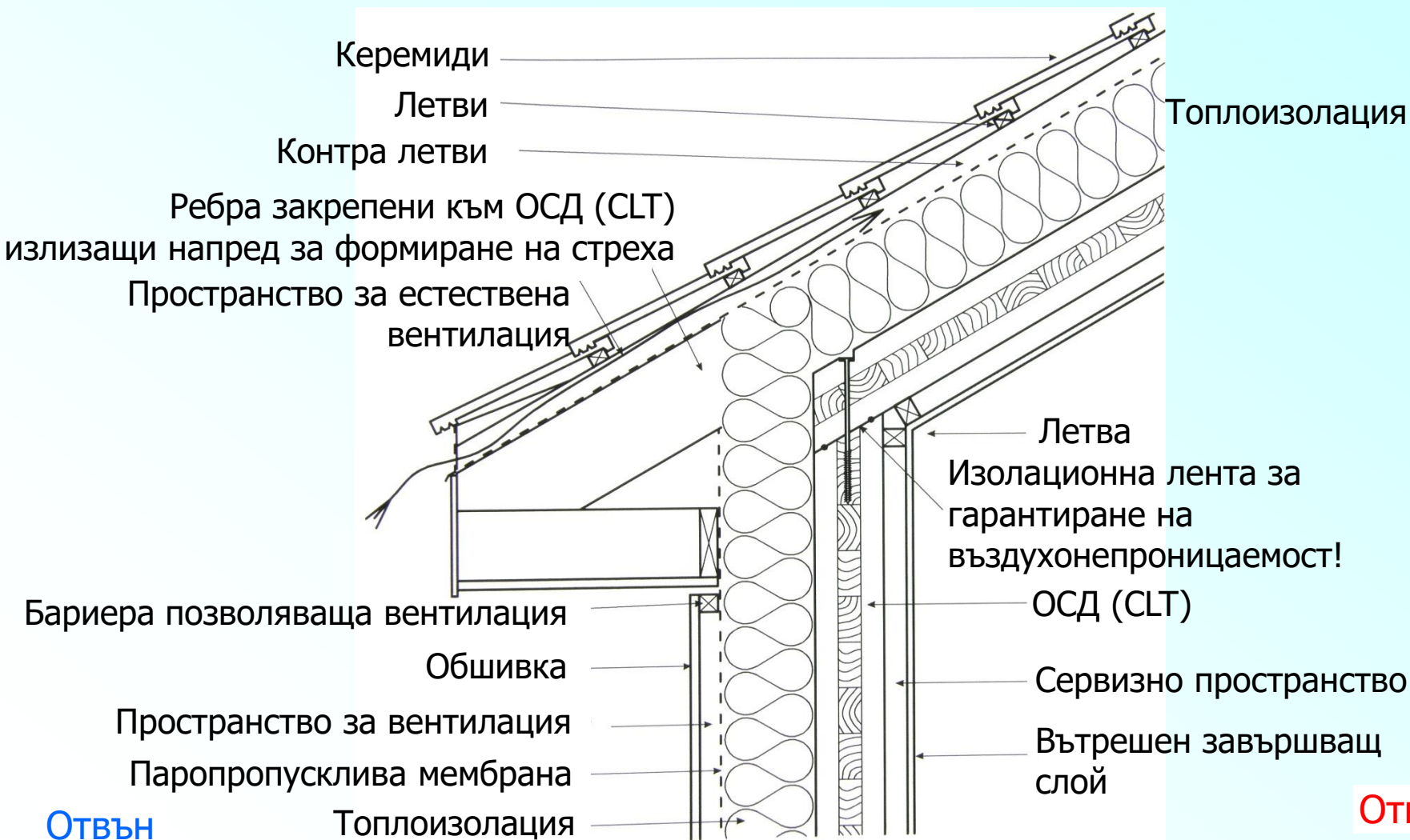
Вертикален разрез през външна стена и двускатен покрив с ПОСД
