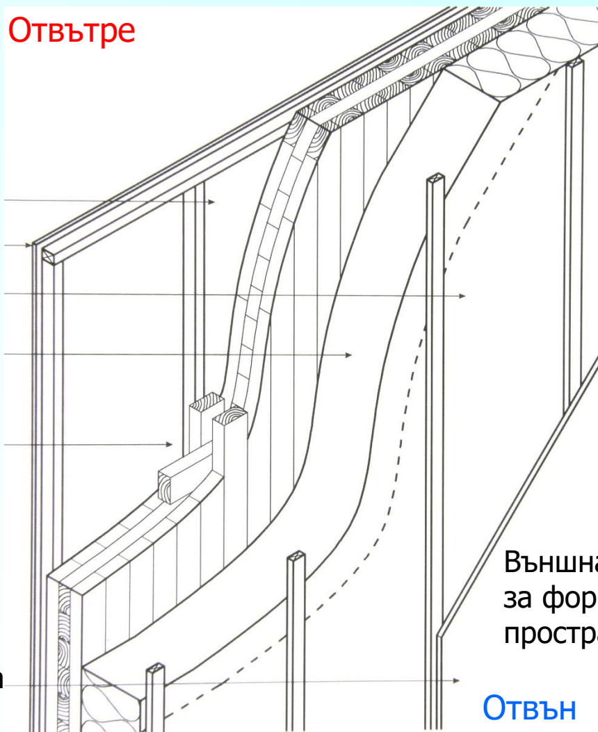
ПОСД и допълнителни слоеве - изометрия
