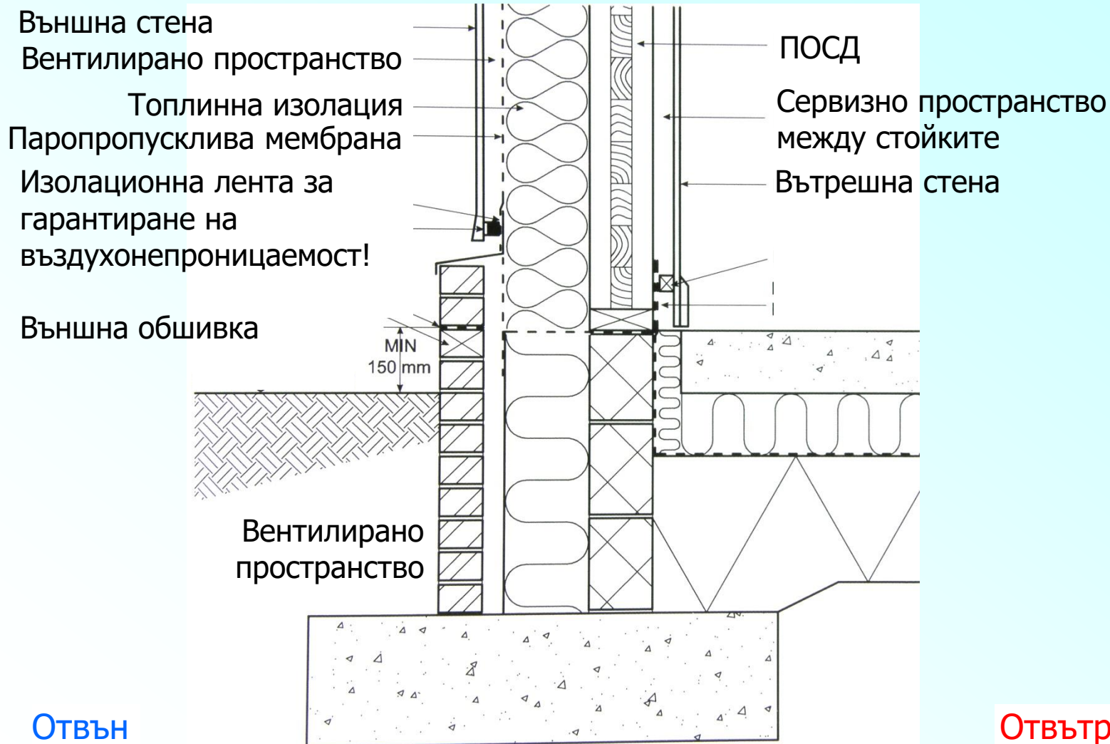
Вертикален разрез през стена от ПОСД с принципно фундиране
