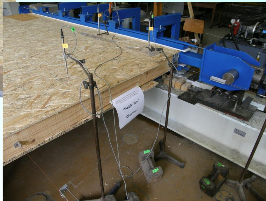
Стенен панел – разкривяване при изпитване
