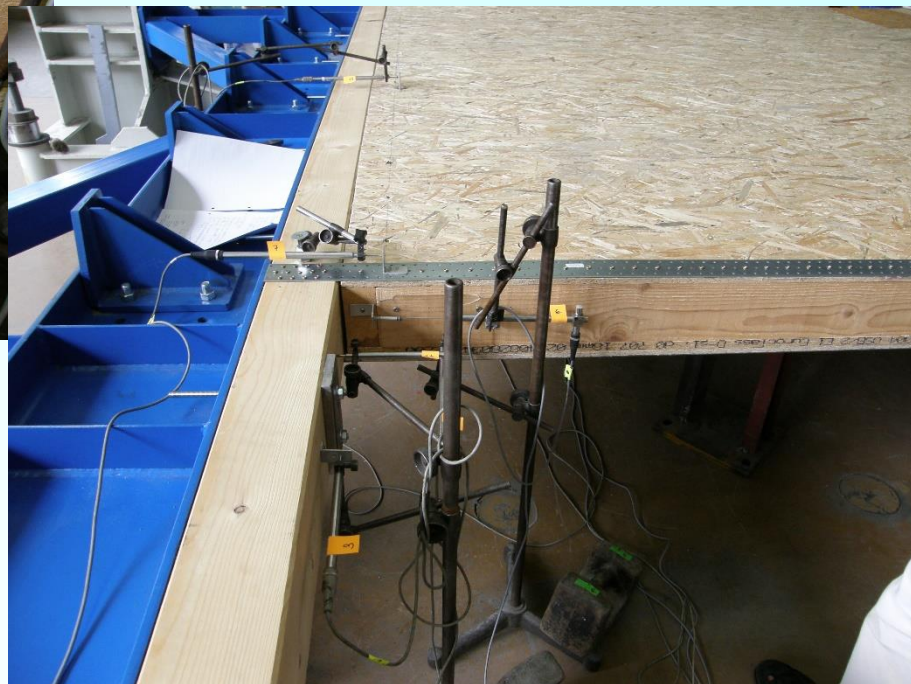
Стенен панел – разкривяване при изпитване
