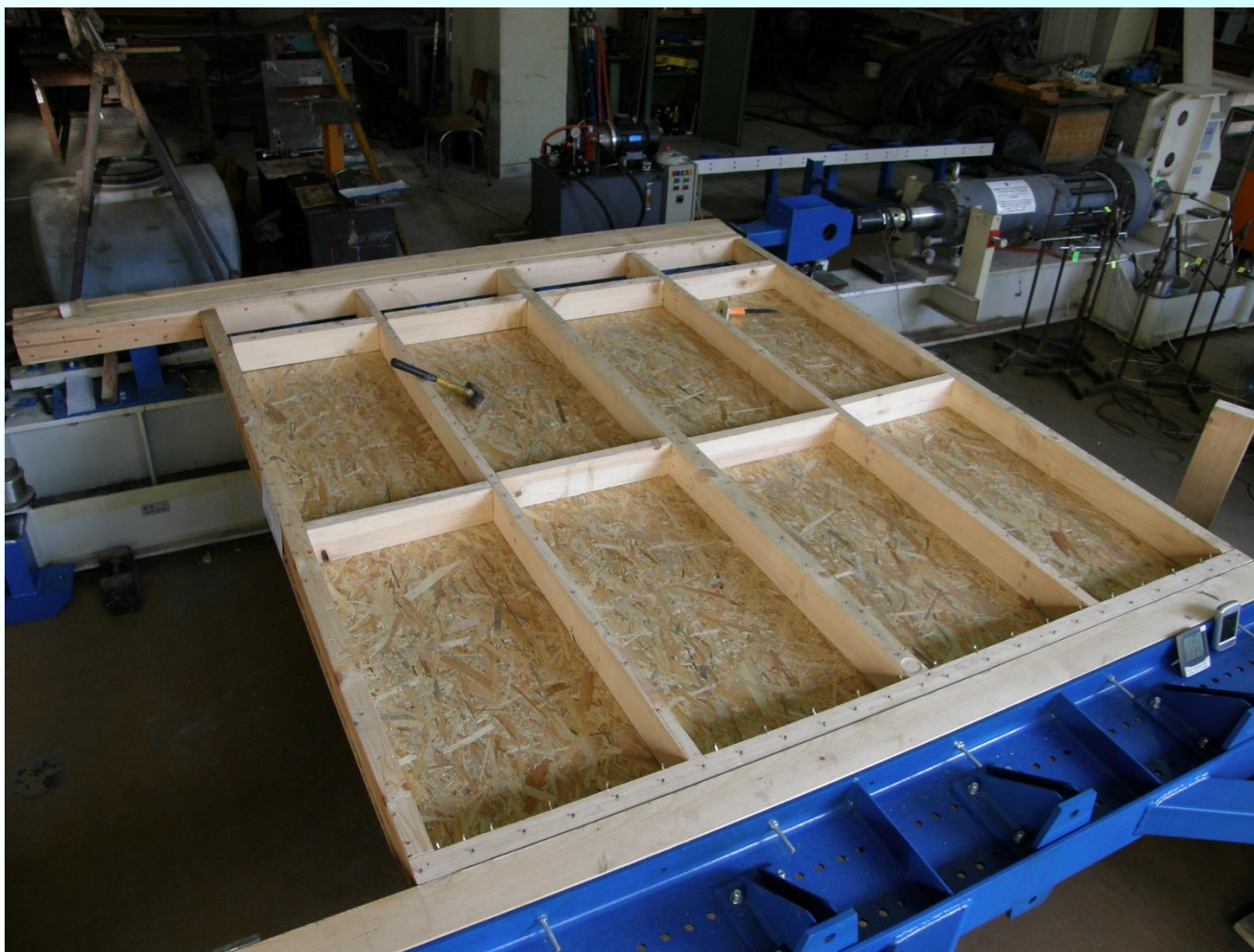
След експеримента и премахнати OSB плочи
